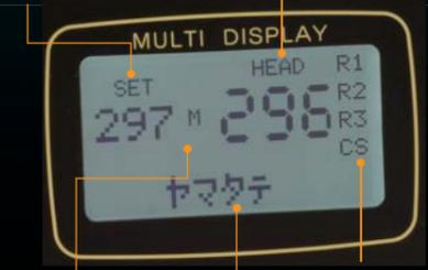
M-GT-GM: 手動モード時には接続されている管制器接続ポート名を表示。リモコンモードや自動モードの時には舵センター以外の位置にツマミがある時に表示。
